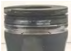
Kolbenring nach 300 Stunden mit Standard-Schmierstoff
