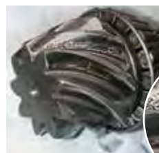
Kegelrad nach 300 Stunden mit Standard-Schmierstoff
