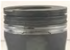
Kolbenring nach 300 Stunden mit Originalschmierstoff
