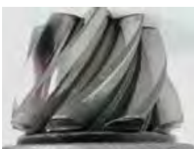
Kegelrad nach 300 Stunden mit Originalschmierstoff
