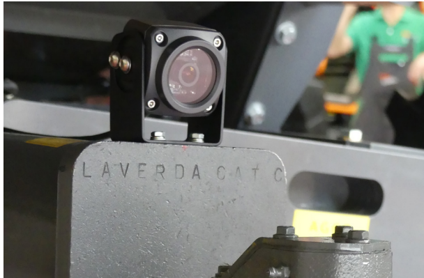
Zugmaul-Kamera X991 470 073 000, Hitch camera, Crochet d'attelage caméra
