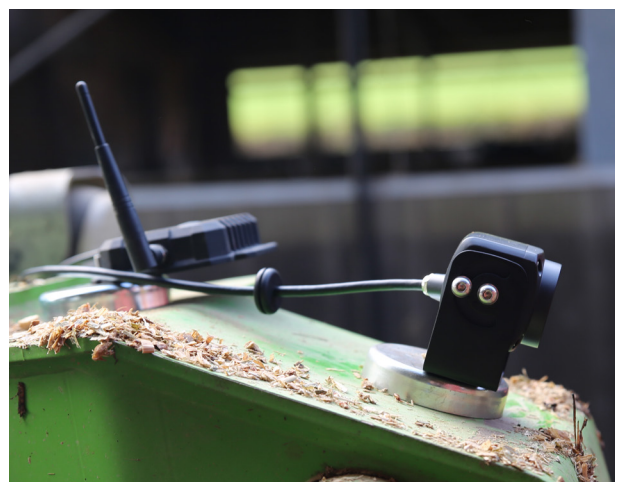
Magnetfuß-Befestigung Kamera Magnetic base attachment camera Montage sur base magnétique de la caméra
