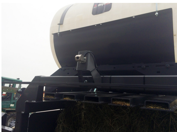
Kamera Ballenauswurf, Camera bale output, Déchargement des balles caméra
