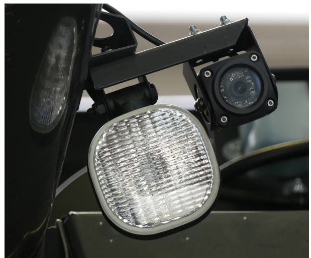
Kamera Abtankrohr X991 470 073 000, Unloading spout camera, Benne à grains caméra
