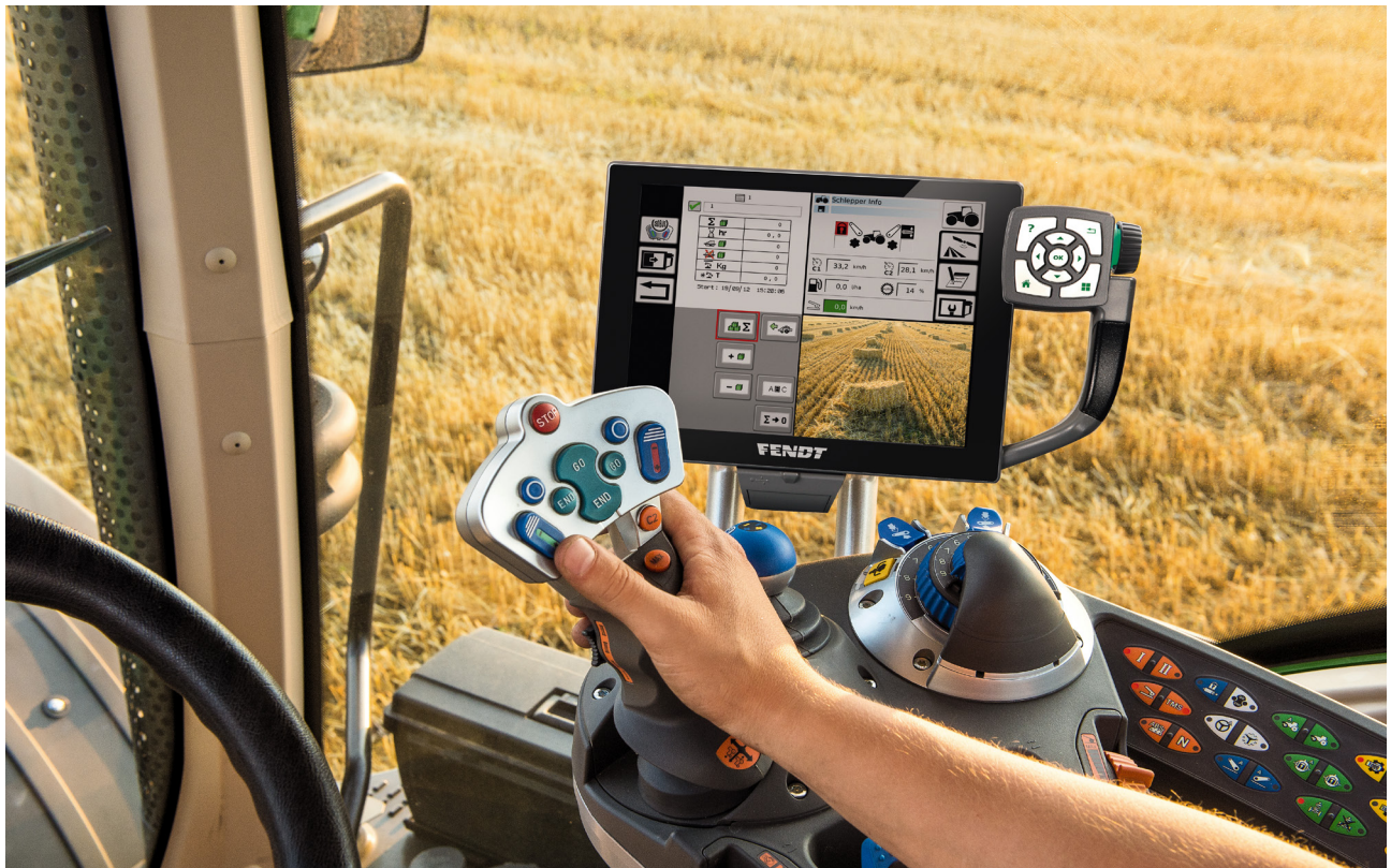
Kamerabild auf Varioterminal 10.4"; Camera image on Varioterminal 10.4"; Image de la caméra sur le terminal Vario 10.4"
