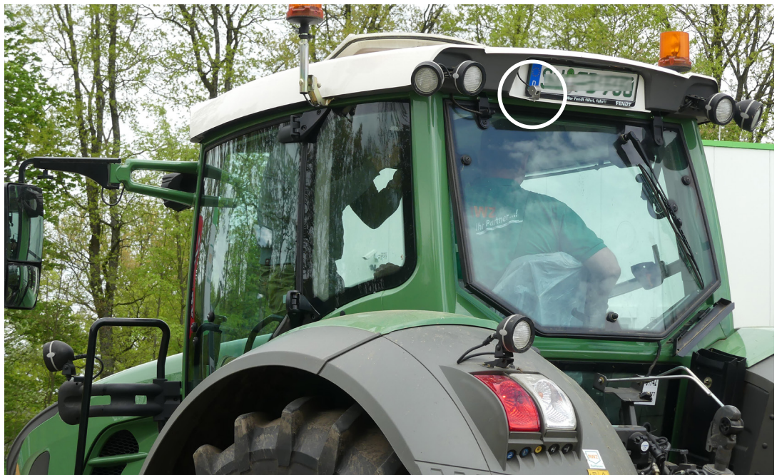
Rückfahrkamera am Traktordach; Rear view camera on tractor roof; Caméra de recul sur le toit du tracteur
