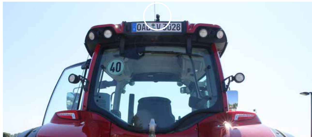
Rückfahrkamera am Traktordach; Rear view camera on tractor roof; Caméra de recul sur le toit du tracteur
