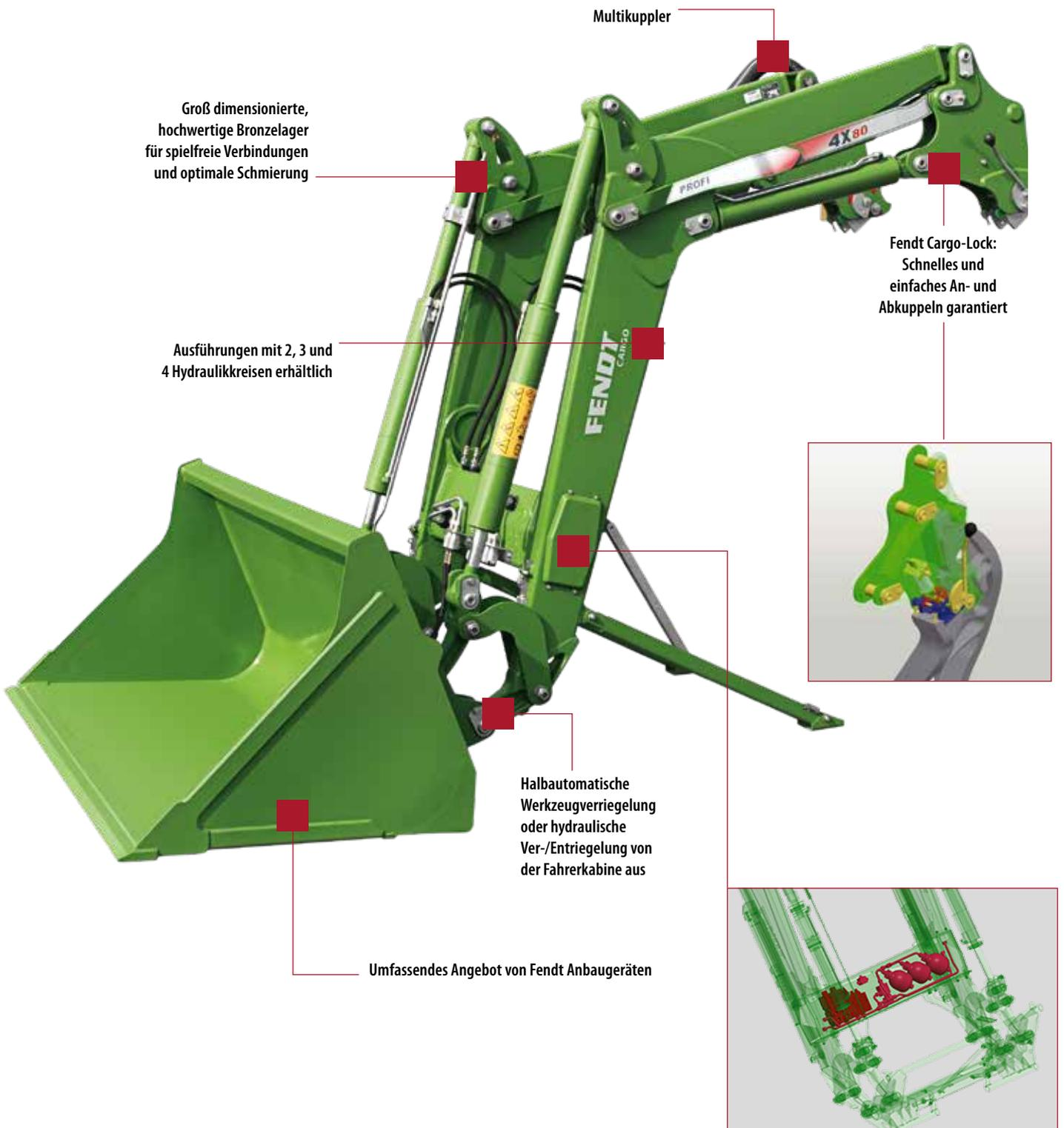
Alle Hydraulikkomponenten sind im Querrohr untergebracht und damit optimal vor Verschmutzungen und mechanischer Beschädigung geschützt
