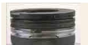
**Kolbenring nach 300 Stunden mit Originalschmierstoff**
