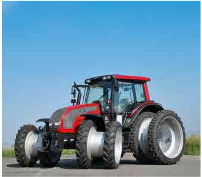
**Bei Zugarbeiten stehen Kraftstoffeffizienz und Produktivität an erster Stelle.** Mit dem richtigen Satz Räder und der Expertise von Grasdorf, resultierend aus jahrzehntelanger Erfahrung, lassen sich Kosten für Landwirte um bis zu 30% senken. Doppelräder oder Großvolumenreifen steigern effektiv die Aufstandsfläche und damit die Verzahnung mit dem Boden und folglich Traktion. Nicht zu vergessen, die bodenschonende Befahrung für mehr Ertrag und nachhaltige Bewirtschaftung.
