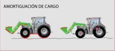
Los depósitos de presión de gas actúan como amortiguadores y evitan que las vibraciones se transmitan al cuerpo del tractor. El sistema de amortiguación integral (1), junto con la suspensión del eje delantero (2) y la suspensión de la cabina (3), garantizan un gran confort de marcha (opcional).
