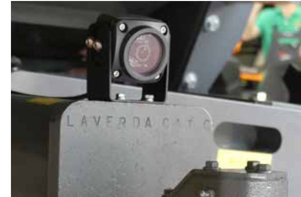
Zugmaul-Kamera X991 470 073 000 Hitch camera Crochet d'attelage caméra
