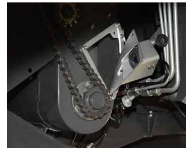
Überkehr-Kamera mit geöffneter Klappe Return feed camera with open flap Système video pour le retour à ôtons avec rabat ouvert
