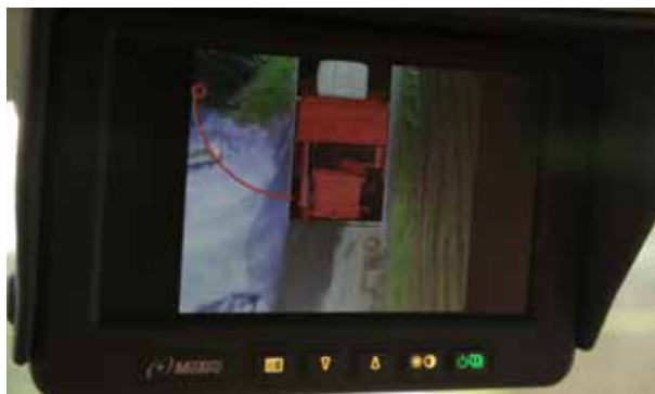
Motec Monitor mit 270°-Heckumsicht X991 470 076 000 Motec monitor with 270° rear view Moniteur Motec avec vue arrière à 270 degrés
