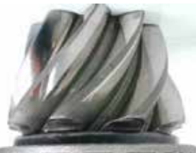
Kegelrad nach 300 Stunden mit Originalschmierstoff
