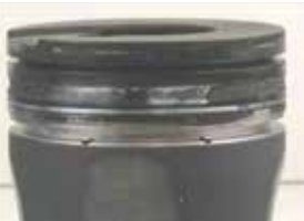
Kolbenring nach 300 Stunden mit Standardschmierstoff
