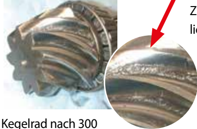
Kegelrad nach 300 Stunden mit Standardschmierstoff
