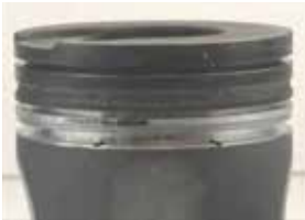
Kolbenring nach 300 Stunden mit Originalschmierstoff
