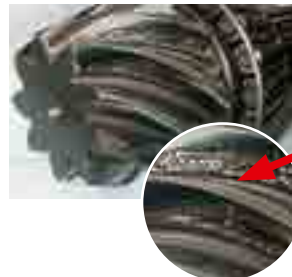
Kegelrad nach 300 Stunden mit Standard-Schmierstoff
