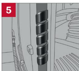
Coloque la cubierta en espiral sobre la barra de sujeción.
