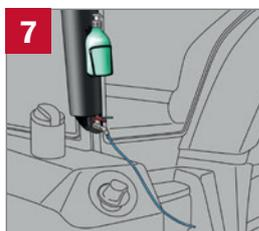
Coloque el tubo en la válvula y córtelo a la longitud deseada.
