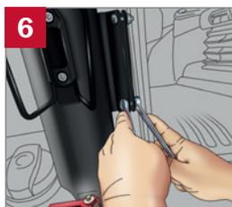
Fije el recipiente con el segundo soporte sobre la barra de sujeción y la cubierta en espiral.
