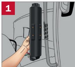
Scegliere i punti di fissaggio della staffa in base all'orientamento desiderato per la valvola.
